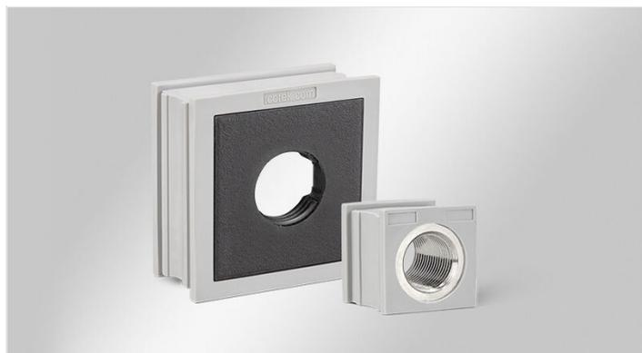
Le AT-M est un joint d'adaptation (basé sur un grand joint KT) avec taraudage métrique intégré, adapté aux systèmes d'entrées de câbles divisibles icotek. Les joints AT-M sont fabriqués en élastomère avec un corps en polyamide. Ils sont disponibles avec filetage/taraudage intérieur M12 x 1,0, M16 x 1,5, M20 x 1,5 et M25 x 1,5.
